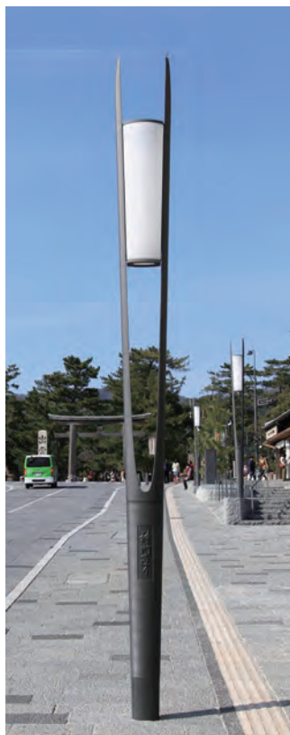
灯具形状は三次元のため アクリルの型成形を使用
